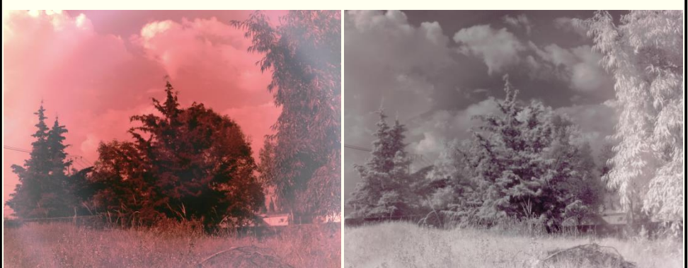
Figura 4. Prueba de captura de imágenes en bandas de rojo (izquierda) e infrarrojo (derecha). La escena muestra: coníferas, un árbol frutal, naturaleza muerta, nubes y cielo abierto. La imagen en rojo muestra la vegetación en un tono más oscuro, demostrando la absorción de la vegetación de esta longitud de onda. La imagen en Infrarrojo muestra un mayor brillo en la vegetación, comportamiento esperado en vegetación con clorofila.
